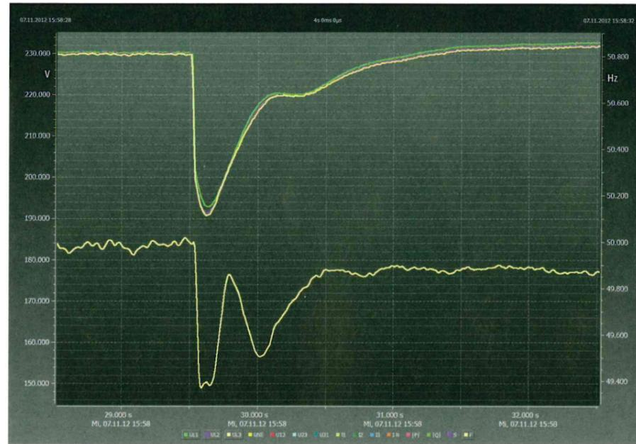
Bild 4. Sternanlauf der 75-kW-Sprinkleranlage im Notstrombetrieb (500-kVA-Notstromdieselaggregat)
