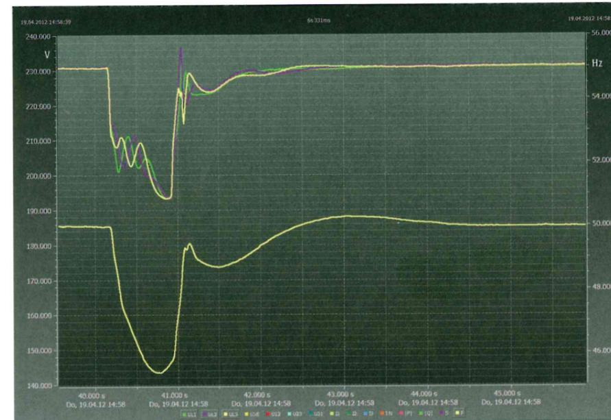
Bild 2. Aufschalten von 60 % (ohmsch-induktiv  $\cos \varphi = 0,8$ ) der Bemessungsscheinleistung des 500-kVA-Notstromdieselaggregats bei der Werksabnahme
