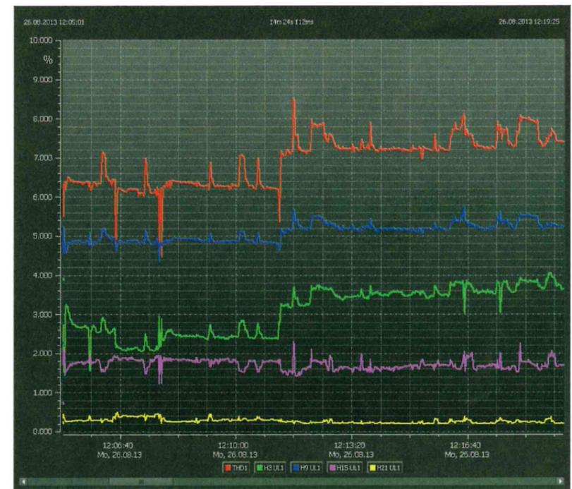
Bild 7.  $THD_u$ ,  $U_{h3}$ ,  $U_{h9}$ ,  $U_{h15}$  und  $U_{h21}$  von L1 an der NSHV-SV im Notstrominselbetrieb (400-kVA-Notstromdieselaggregat)
