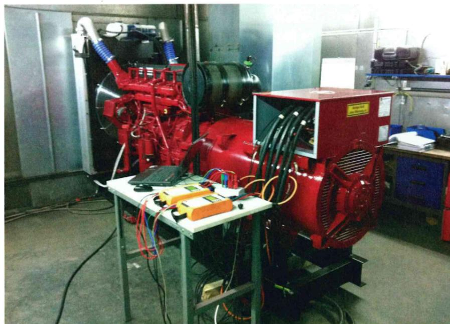
Bild 1. Messaufbau des Netzanalysators PQ-Box 100 an einem 500-kVA-Notstromdieselaggregat bei der Werksabnahme
